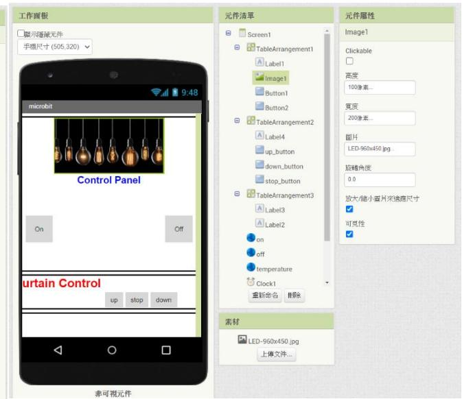
圖 9.10 (Table arrangement 1 中的 image1 元件屬性)\*
