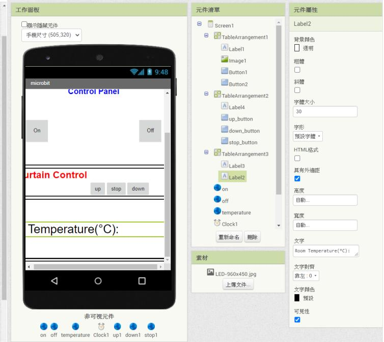
圖 9.20 (Table arrangement 3 中 label2 元件屬性)
