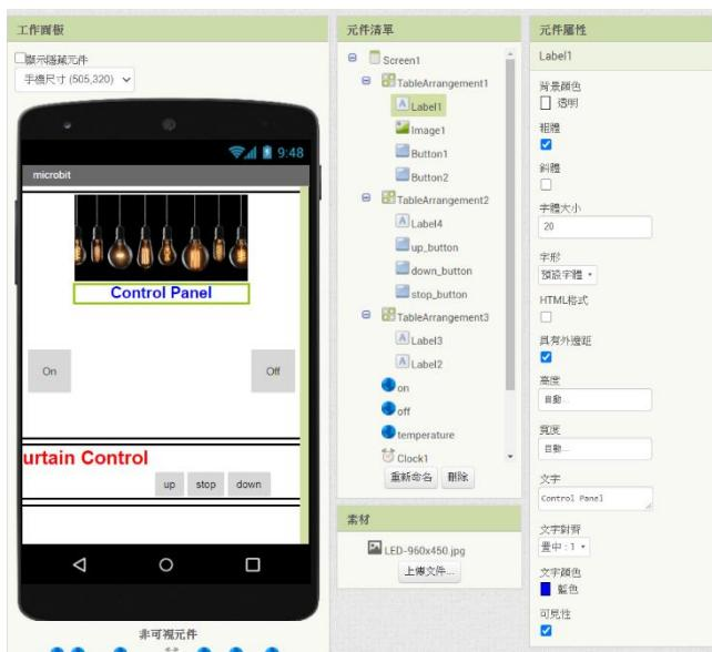
圖 9.9(Table arrangement 1 中 label1 的元件屬性)
