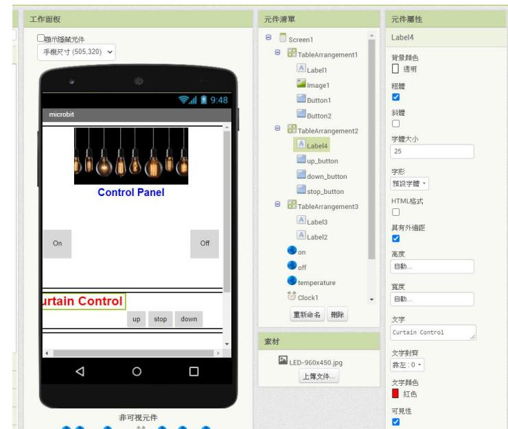
圖 9.14 (Table arrangement 2 中 label4 的元件屬性)
